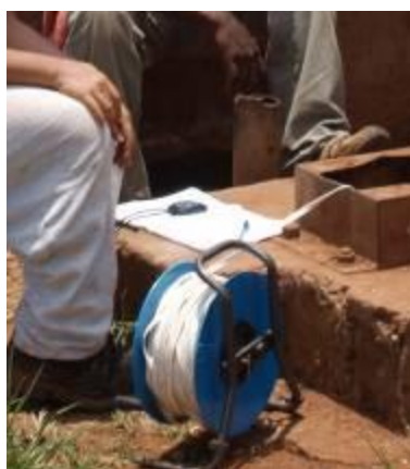
Gráfico 3. Ensayo de bombeo en un pozo para determinar la capacidad del pozo, el tipo de bomba óptima a utilizar y su profundidad de instalación. Fuente: ESF
