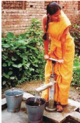
Gráfico 15. Bomba de acción directa tipo TARA en la india
