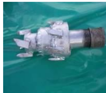
Gráfico 11. Método de perforación manual con Rota sludge y cabeza de corte.
