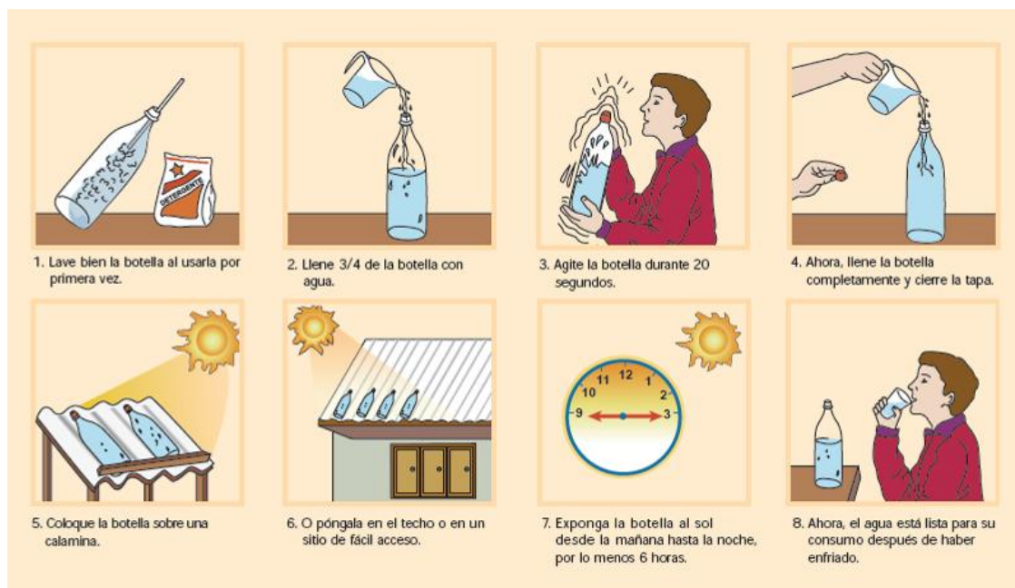
Gráfico 21. Procedimiento para la exposición en el método Sodis. Fuente: Fundación Sodis, 2003.
